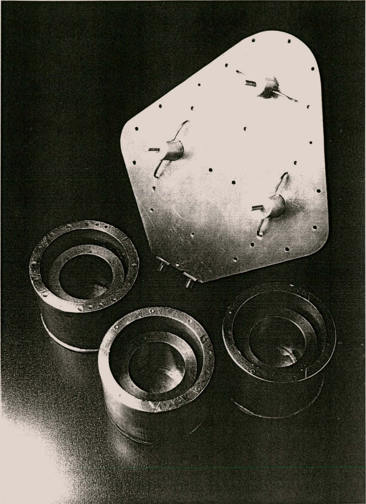
Figuur 4.13 : Aansig van filter met dekselplaat verwyder
