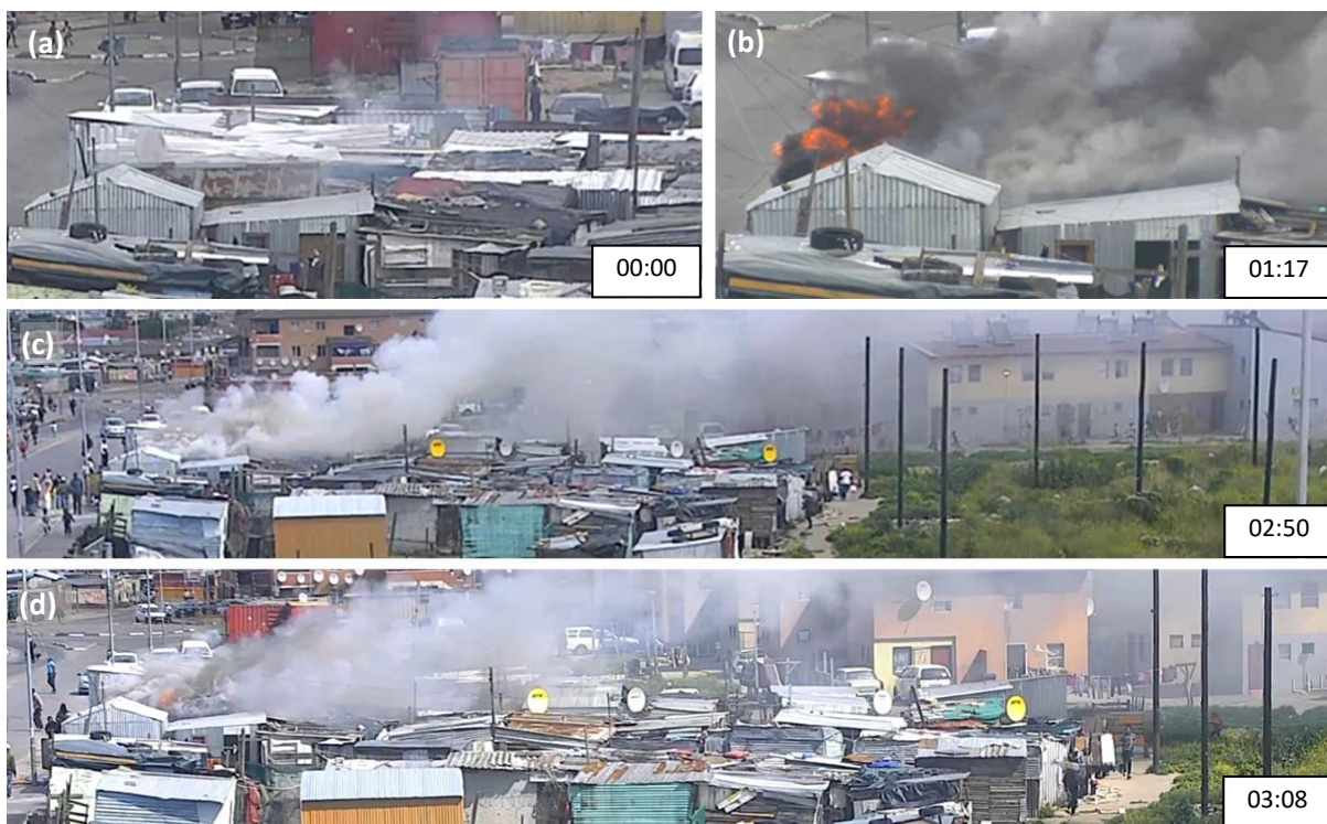
Fig. 5-6: Fire development. (a) t=00:00 . (b) t=01:17 . (c) t=02:50 . (d) t=03:08 .
