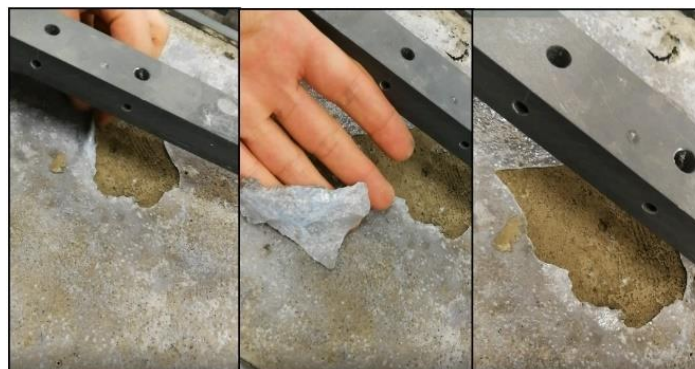
Figuur 4.15: Laag gevorm deur die petroleumharsemulsie (KA2)
