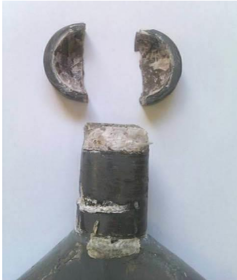
Figure A.5 - Fan blade failure
