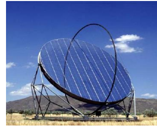
(d) 150 m 2 large carousel heliostat, PSA, Spain (Kolb et al. , 2007)
