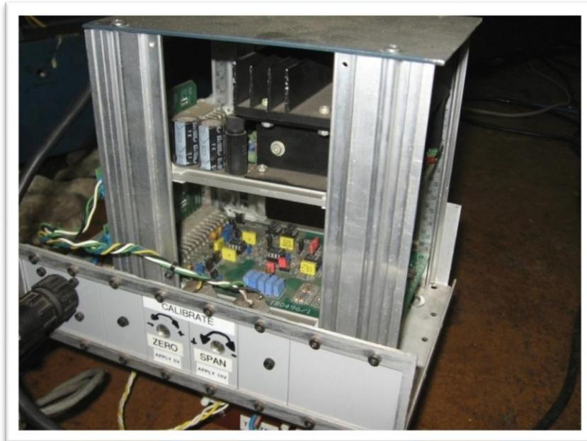
**FIGURE 30 - THROTTLE ACTUATOR CONTROLLER**
