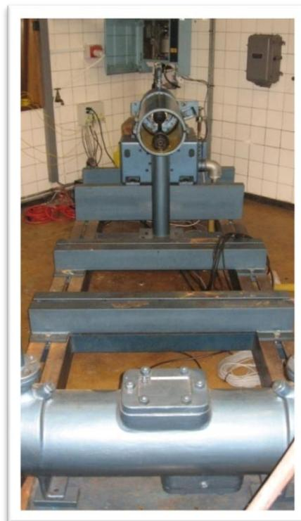
FIGURE 14 - STRIPPED DOWN TEST BED BEFORE ENGINE INSTALLATION
