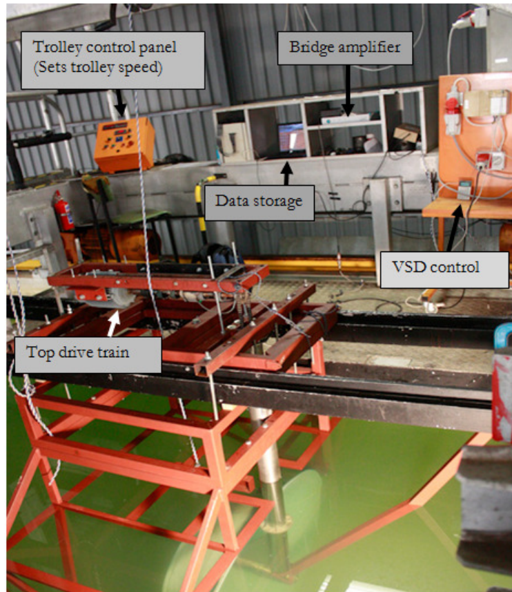
Figure 8.2: Actual test setup.
