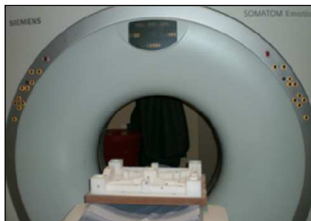
Figuur 3-4 Die maatstafpart word deur 'n Siemens Emotion 16-snit GT-flikkergram geskandeer.
