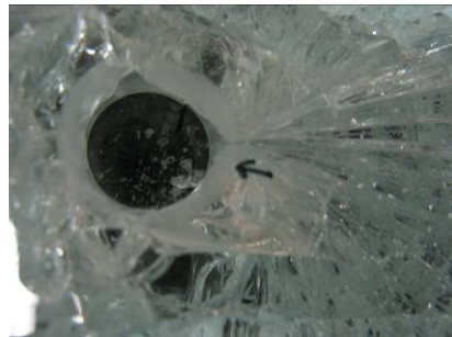
Figure A20.4 Actual fracture origin
