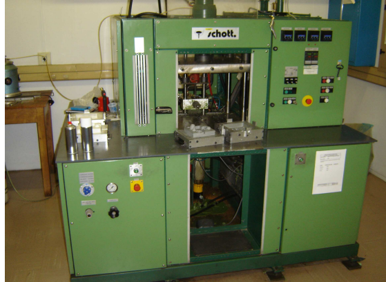
a. Schott 20 Ton Wax Injection Machine
