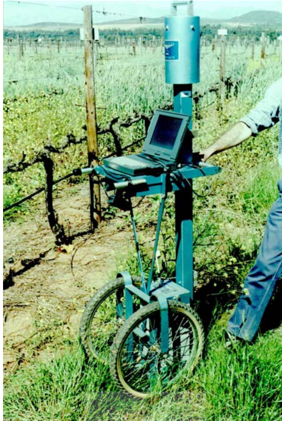
Figuur 6: Penetrometer met rekenaar wat vir penetrometerstudies gebruik is.
