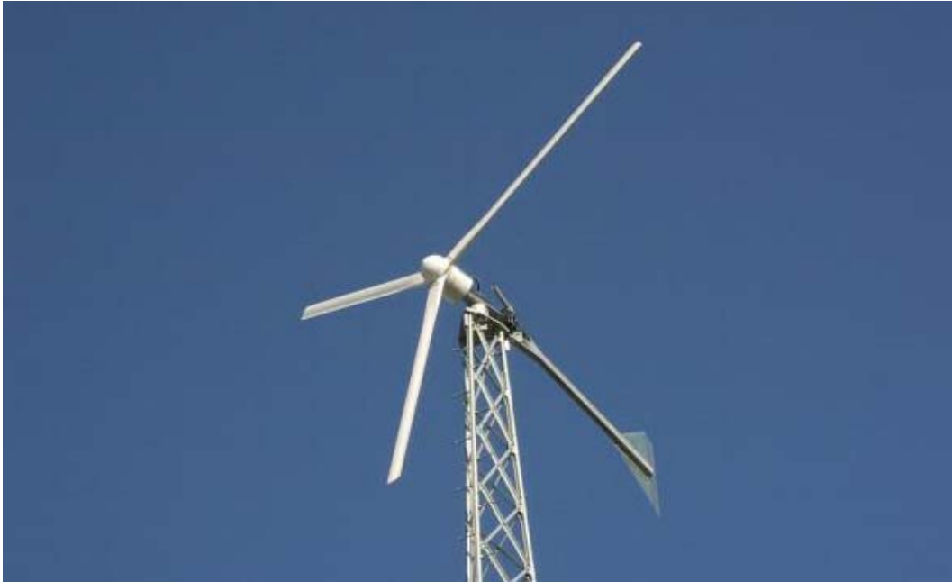
Figure 6.3: Fortis Alizé 10 kW wind turbine (Kuikman, 2008)
